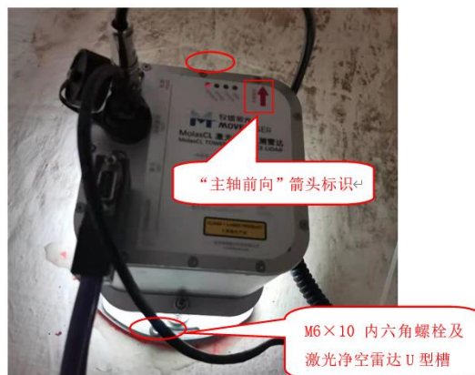
图 3-12 激光净空雷达安装
