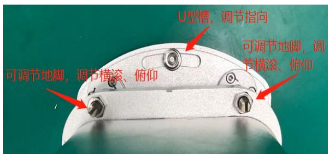
图 3-13 激光净空雷达姿态调整结构
