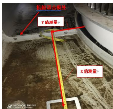
图 3-8 X/Y 值测量标识位置
