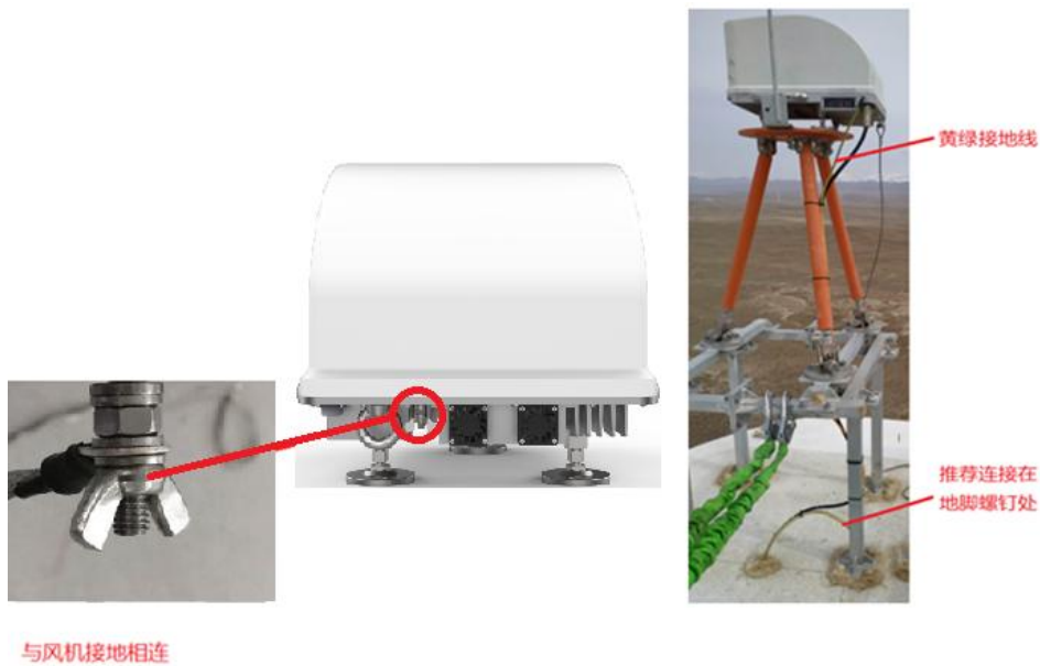
图 40 OH 接地示意图
