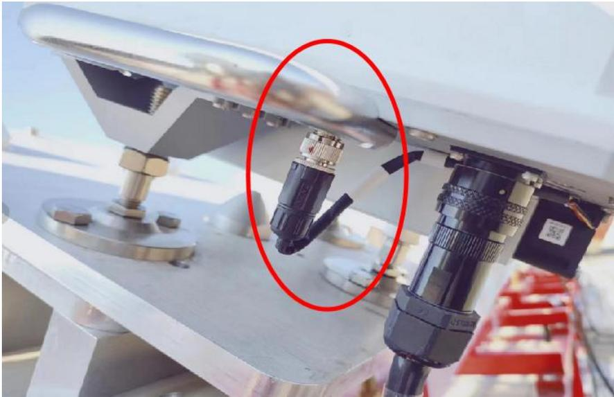
图 60 线缆接头示意图
